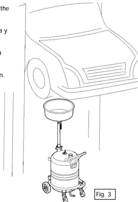
**Pump discharge/ Descarga por bomba/ Décharge pour pompe/ Entleerung der Pumpe**
